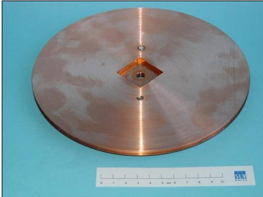
**Bild 2.** Prüfvorrichtung aus technisch reinem Kupfer mit Probenöffnung.
