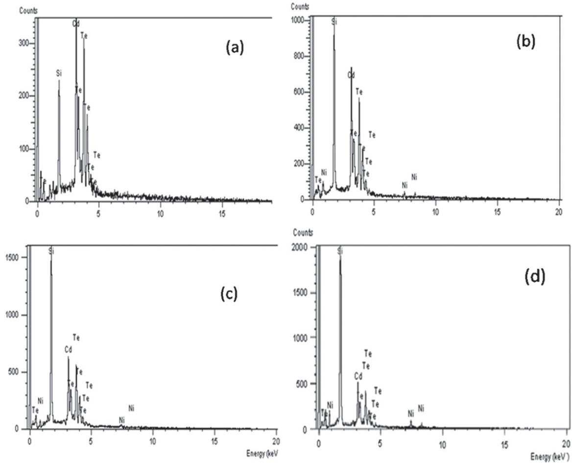
**Figure 2.** EDX spectra of  $\text{Cd}_{1-x}\text{Ni}_x\text{Te}$  thin films with (a)  $x=0\%$ , (b)  $x=5\%$ , (c)  $x=10\%$  and (d)  $x=15\%$ .
